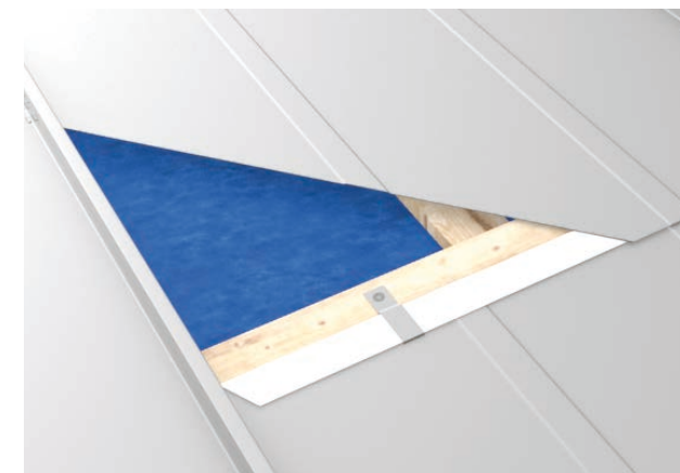
ABB. 15 Paneel-Verbindung durch Biegen
