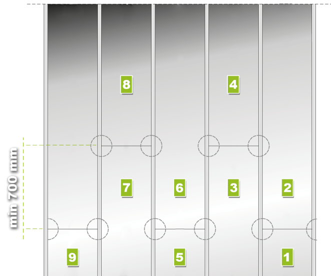
ABB. 19 Montage-Reihenfolge der Paneele – mit den Kreisen sind die Stellen gekennzeichnet, an denen die Schlösser ausgeschnitten werden
